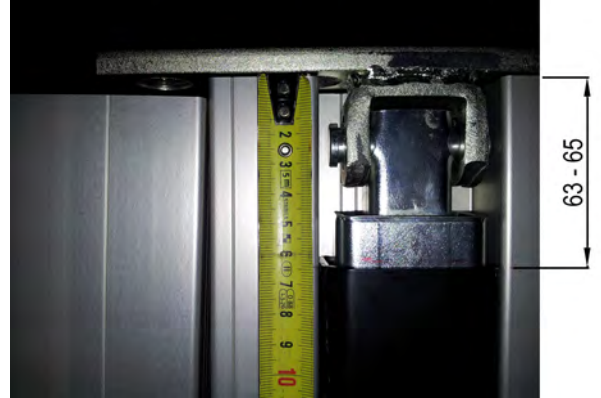
Montáž zvedacího sloupku DG do Al rohového sloupu
